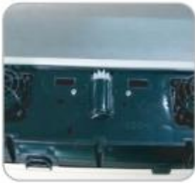
4Circulation fan & turning motor
